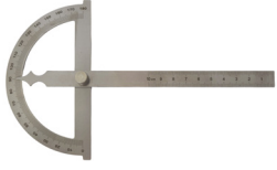
أداة قياس الزوايا إلى 180 درجة
